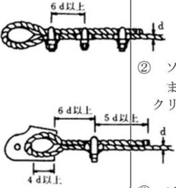
① クリップの適否を調べる。<br>[クリップ止め]<br>② ソケットの装着状態を調べる。<br>また、クリップ併用の場合は、<br>クリップの適否を調べる。<br>[コッター止め]<br>③ ソケットの亀裂及び変形の有無<br>を調べる。<br>[コッター止め]<br>④ ピン及びピンの抜け止めの異常<br>の有無を調べる。<br>[合金詰めソケット止め]<br>⑤ 腐食の有無を調べる。<br>[合金詰めソケット止め<br>及び圧縮止め] | ① クリップの方向が正しく、間隔は6d以上であり、締付けが適正であること。<br>② コッターはソケット長さいっぱいに入り、かつ、ロープに締めしろがあること。<br>ソケットとコッターの接触は4d以上であること。<br>③ 亀裂及び変形がないこと。<br>④ ピン及びピンの抜け止めに異常がないこと。<br>⑤ 腐食がないこと。 |
