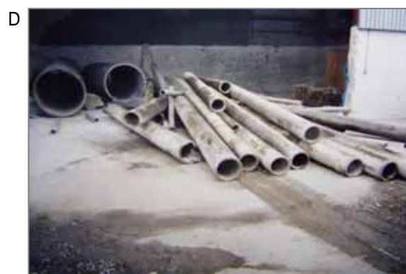
D 水道管の集積。尚、石綿セメント管という標記は上下水道用、石綿セメント円筒という標記は煙突など建築用に用います。
