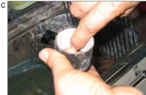
C 石綿リボン作業。歯科技工の作業では石綿リボンをよく使っていました。写真は歯のつめもの作成の際に使用する筒(リング)の内部に石綿リボンを貼り付けているところです。
