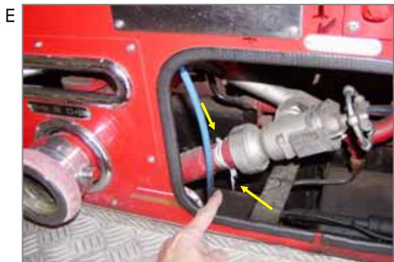
ポンプ車。圧力をかけますので、ゆるいネジ山や継ぎ手があれば水が漏れてしまいます。そこで以前は、石綿系やテープが使用されており、補修・交換時にはばく露する可能性があります。
