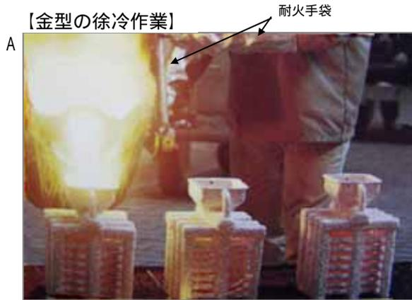
【概要】金型を用い、溶かした金属(アルミ合金その他)等を入れ各種製品を作ります。金型を用いた製品製造の際には、高温であること、徐冷するなど石綿保温材はかかせませんでした。作業者も石綿の耐熱服や手袋をしていました。
