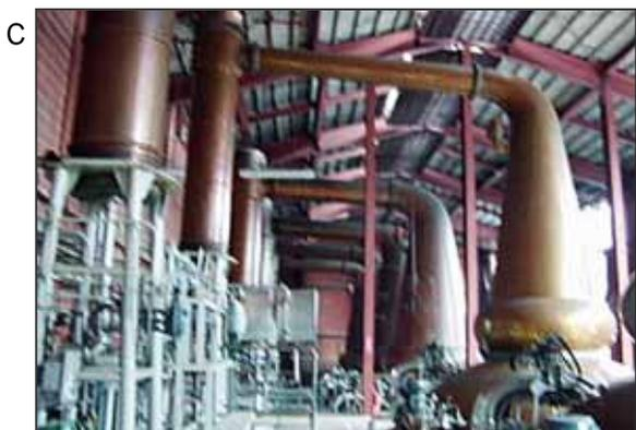
C 洋酒工場の蒸留装置。寒冷地にあるため建物の結露防止で吹きつけ石綿が施工されています。装置内に石綿粉じんが入ることはありませんが、吹きつけ石綿の劣化や損傷により、作業員が石綿粉じんにはく露する可能性があります。
