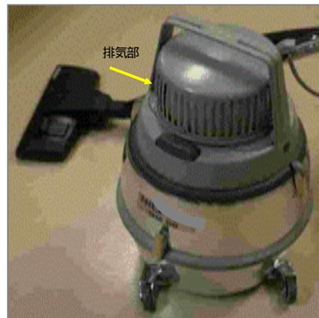
石綿粉じんを除去する HEPA フィルターが装着されている掃除機です。通常の掃除機の排気部は後面や下にありますが、排気による床の粉じんの再飛散防止のため、排気部が上部にあるのがわかります。
