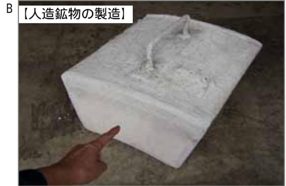
【概要】これは高温・高圧で人造鉱物を作りだす炉の石綿断熱材(中にシリカ系、外周部はクロス)。取っ手まで石綿クロスが巻かれています。ニーズによって多様な形状のものがありました。劣化や破損により、ばく露の可能性がります。
