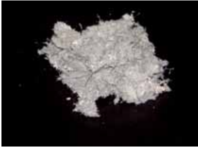
青石綿(クロシドライト)
