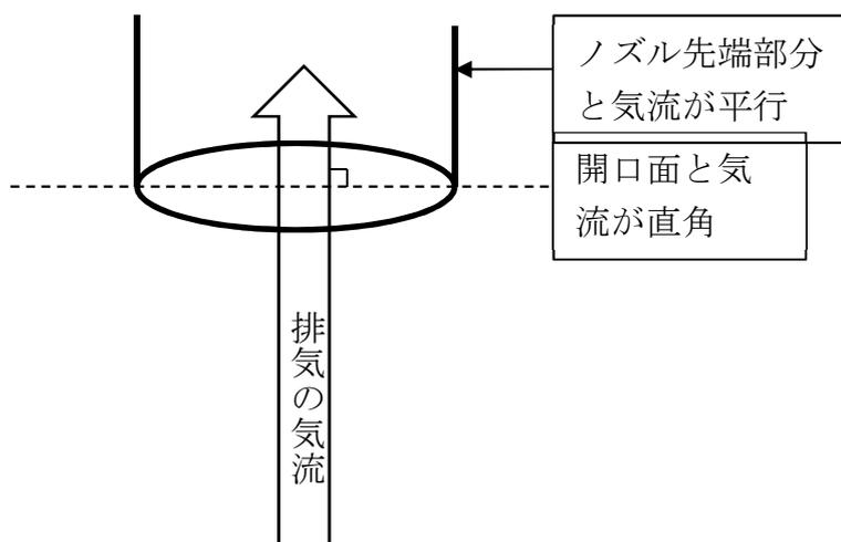
図3 L型ノズルを使用した排気測定例
