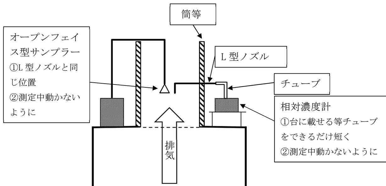
図2 L型ノズルの先端部分と排気の気流の位置関係
