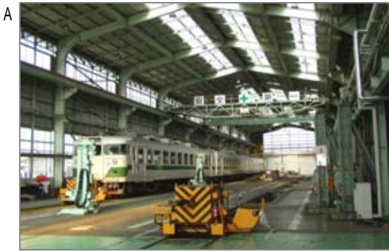
【作業環境】車両検査場・修理場。安全運行には点検、部品交換など整備は重要です。レールの下にはビットがあって下からも覗けます。建物はスレート葺き屋根・壁のものもあります。
