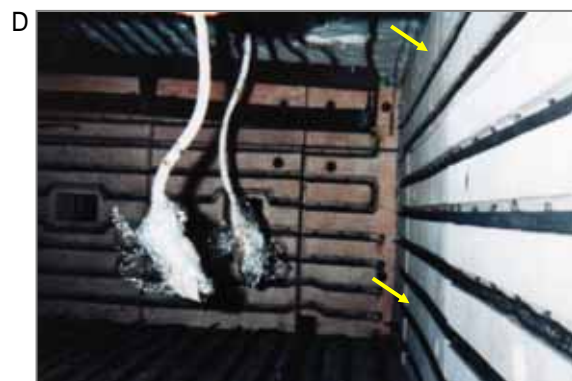
加熱炉内ポピン・ヒーターの絶縁材。炉の局所加熱装置にあるポピンや電気炉のニクロム線の下敷きとして石綿テープ他が使用されています。修理・交換時にばく露の可能性があります。
