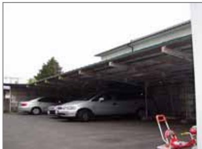
駐車場屋根裏(一方向開放型の駐車場。屋根裏に石綿フェルトが張られています。)
