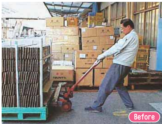
▶ 人力によるジャッキを使用していたが、腰にかかる負担が大きく腰痛が発生していたため電動ジャッキを導入した。
